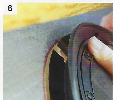
6 Sæt basering i undertaget ved dertil indrettet spor.
